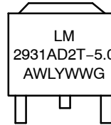
D2PAK D2T SUFFIX CASE 936
